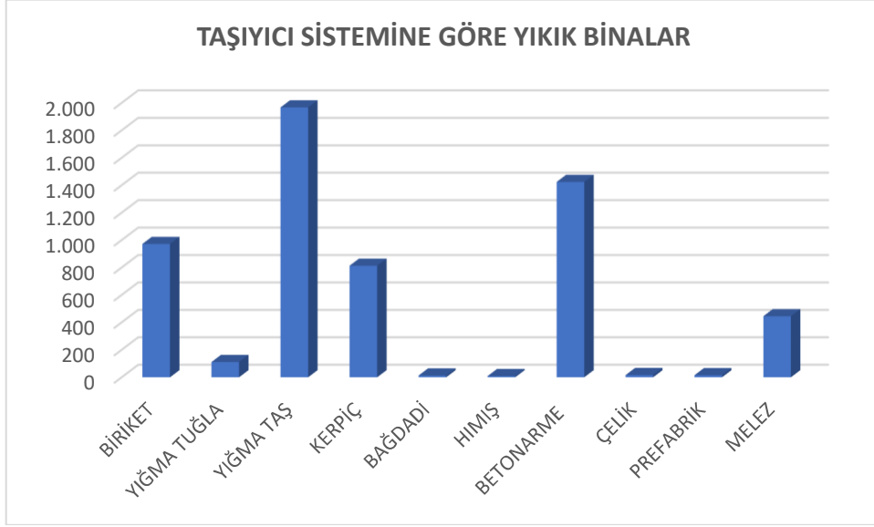
Şekil 5. Adıyaman İli için taşıyıcı sistem türlerine göre yıkık binalar.
