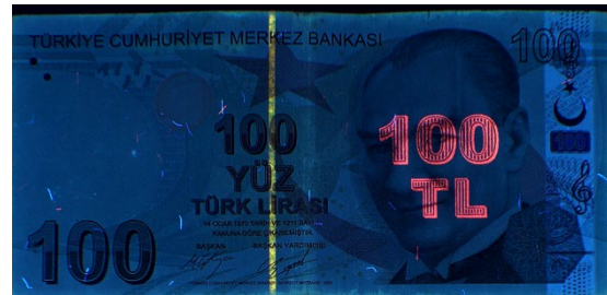
Şekil 3: Gerçek para ile sahte paranın VSC-8000 ile 365 nm UV altında karşılaştırması
