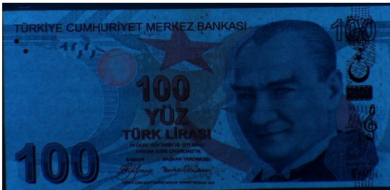
Şekil 3: Gerçek para ile sahte paranın VSC-8000 ile 365 nm UV altında karşılaştırması
