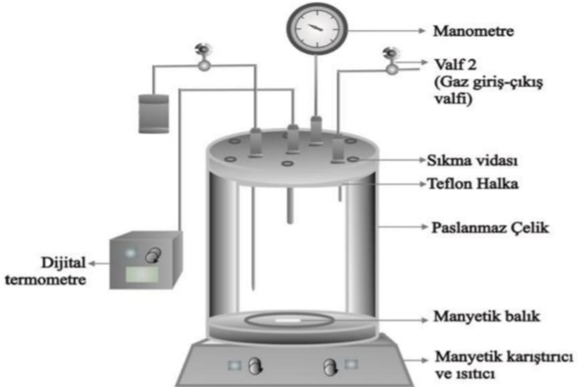
Şekil 5. Yüksek basınca dayanıklı paslanmaz çelik reaktör (Bayar, 2016)
