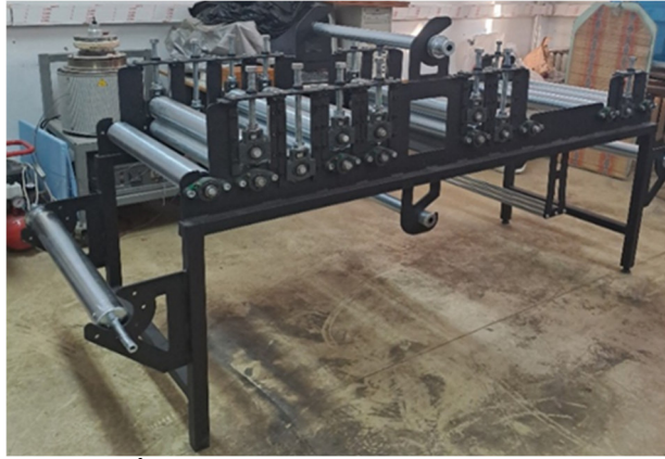
Şekil 2. İmal edilen Prepreg sarım makinesi
