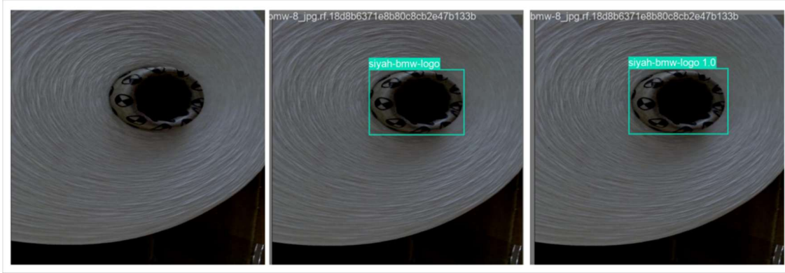
Görsel 4. YOLOv9t ile konik tespiti: sırasıyla orijinal görüntü, tespit görüntüsü, tanıma sonucu
