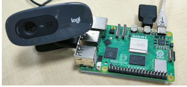
Şekil 7. Testte Kullanılan Raspberry 5 ve Webcamden Oluşan Donanım Sistemi
