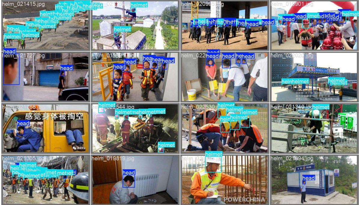
Şekil 8. Doğrulama Kümesi Üzerinde Yürütülen Baret / Baş Tespiti Testlerine Dair Örnek Sonuçlar.
