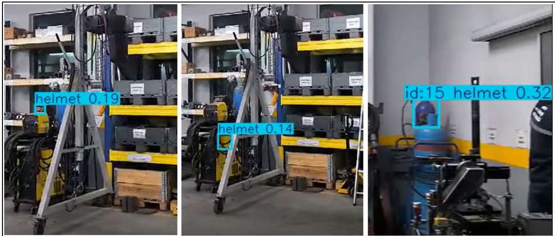
Şekil 16. Arka planda Bulunan “Baret” Olmayan Objelerin “Baret” Olarak Tespit Edildiğine Dair Örnek Görseller.
