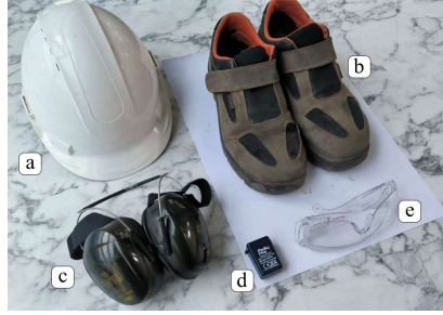
Şekil 1. Tehlikeli Alanlarda Kullanılan KKD'lere Dair Örnekler (a. Baret, b. İş güvenliği ayakkabısı, c. Kulaklık, d. Kulak tıkacı, e. Güvenlik gözlüğü).
