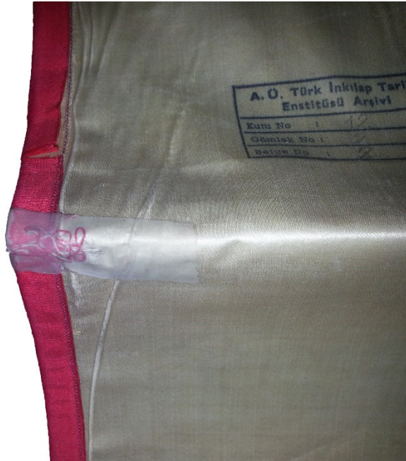
Şekil 5 1 numaralı belgenin katlanarak muhafaza edilmesinden kaynaklı deformasyon ve eski onarımdan kalan bant
