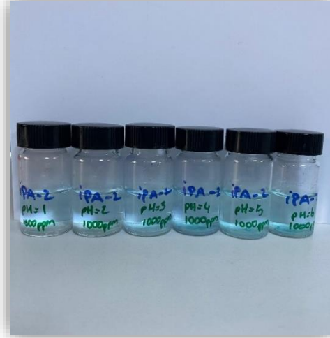
Şekil 4. 4a.0,01g iPA-2 polimerinin tartım işlemi, 4b. 24 saat bekletilen çözeltiler
