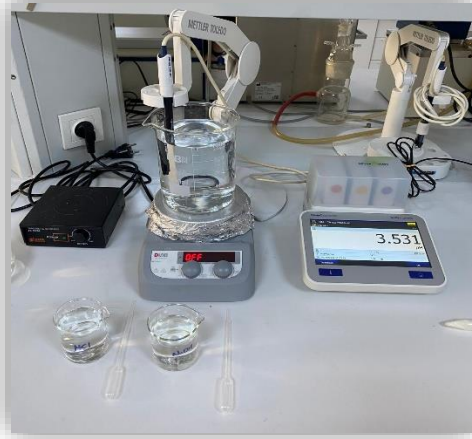
Şekil 3. 3a. pH sularının hazırlanma aşaması, 3b. CuSO 4 .5H 2 O stok çözeltisinin seyreltilmesi.
